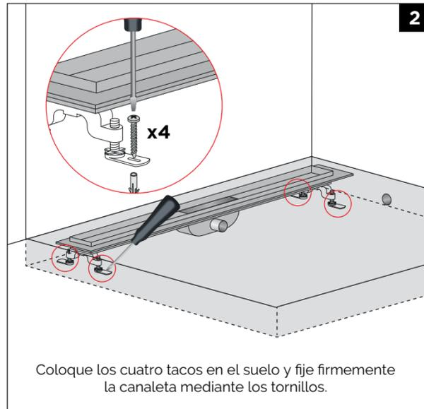
Coloque los cuatro tacos en el suelo y fije firmemente la canaleta mediante los tornillos.
