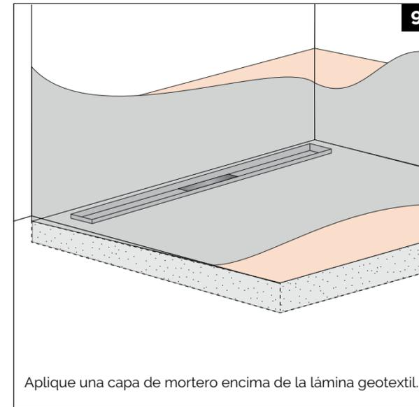
Aplique una capa de mortero encima de la lámina geotéxtil.
