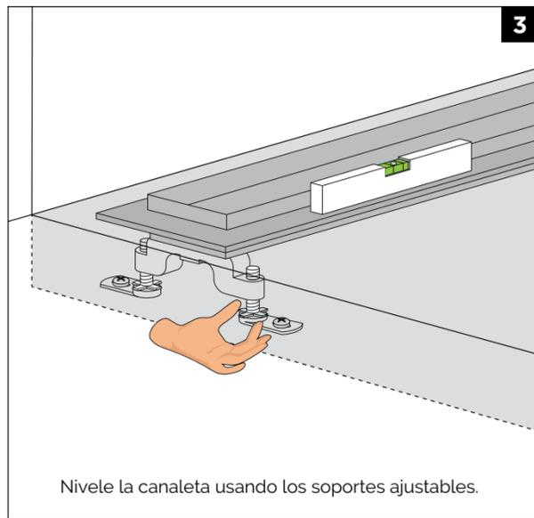
Nivele la canaleta usando los soportes ajustables.
