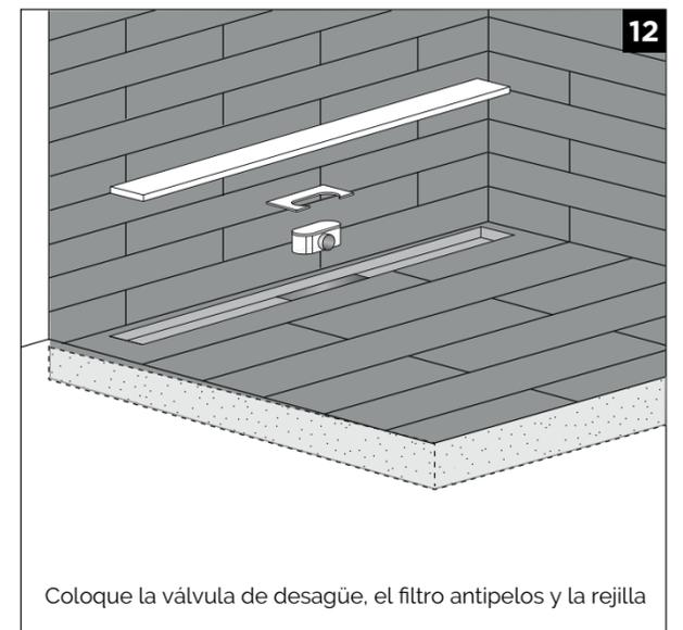
Coloque la válvula de desagüe, el filtro antipielos y la rejilla
