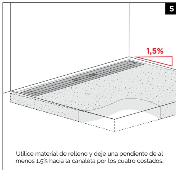
Utilice material de relleno y deje una pendiente de al menos 1,5% hacia la canaleta por los cuatro costados.
