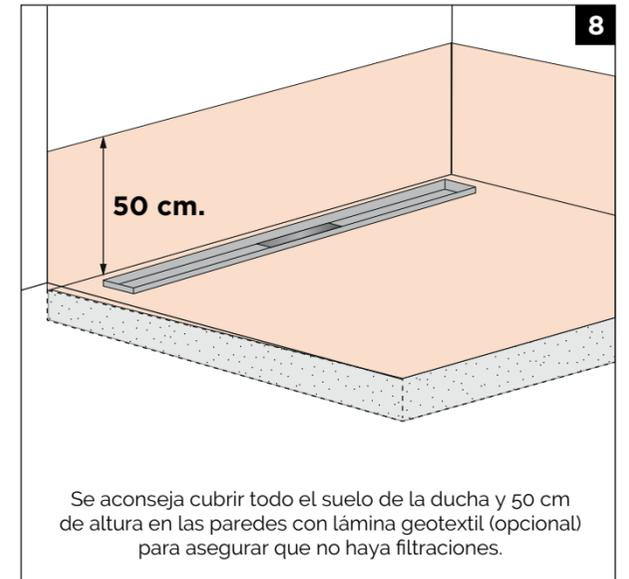
Se aconseja cubrir todo el suelo de la ducha y 50 cm de altura en las paredes con lámina geotéxtil (opcional) para asegurar que no haya filtraciones.
