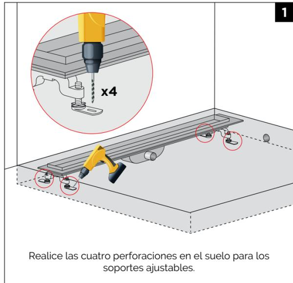
Realice las cuatro perforaciones en el suelo para los soportes ajustables.
